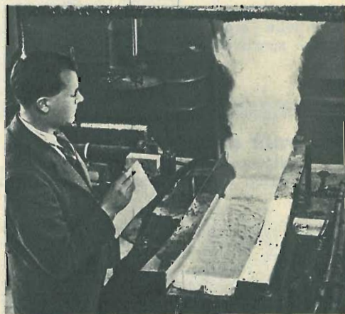
Un operatore sottopone un nuovo tipo di schiuma per estinguenti. Le fiamme sono prodotte dalla combustione di gas di petrolio.
