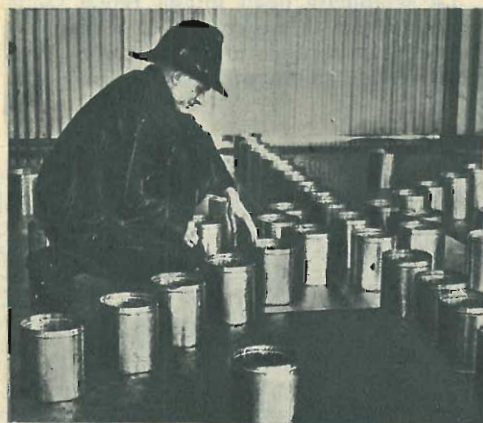
Sopra: Determinazione dell'infiammabilità di miscele gassose mediante una scintilla provocata dall'urto di due barre metalliche. Sotto: Prova di un estintore a pioggia. I vasi di uguale capacità piazzati simmetricamente servono a rilevare l'uniformità della pioggia e la sua efficienza.
