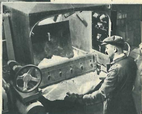
A sinistra: Impianti modernissimi impiegati dall'industria inglese delle materie termoplastiche. Sotto: Il materiale plastico è mescolato a caldo col colorante e con materia inerte come legno in polvere o anche amianto. Quindi, dopo la laminazione, esso viene nuovamente macinato per essere usato negli stampi come polvere.
